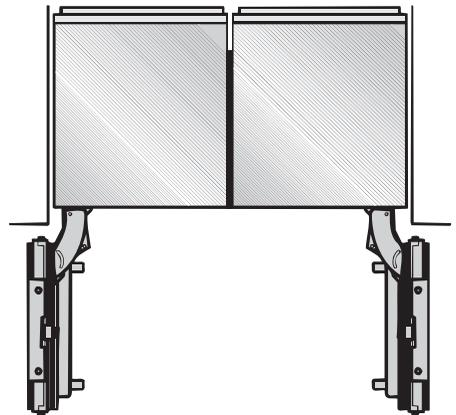
Si los aparatos se instalan directamente uno al lado del otro (sin una división), será necesario acoplarlos juntos empleando el "Equipo de combinación".
