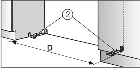
La distancia "D" entre las abrazaderas antivuelco ② es el ancho del aparato.
