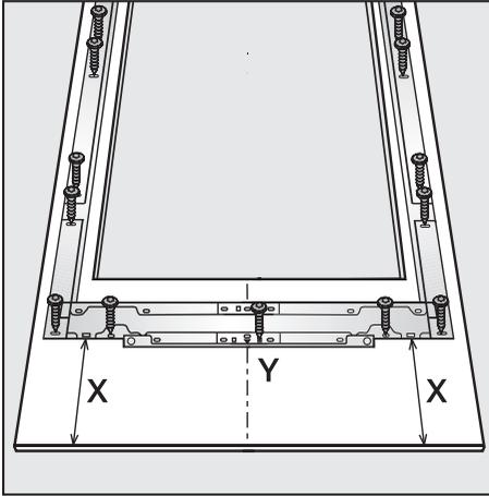
La abrazadera viene con muchos orificios para las diferentes opciones de diseño de las puertas personalizadas.
