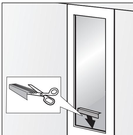
Si el ancho del marco es angosto, es posible que se tenga que acortar la parte lateral de la cinta. Para determinar el largo requerido de la pieza lateral, se incluye una pieza de prueba con la tira.
