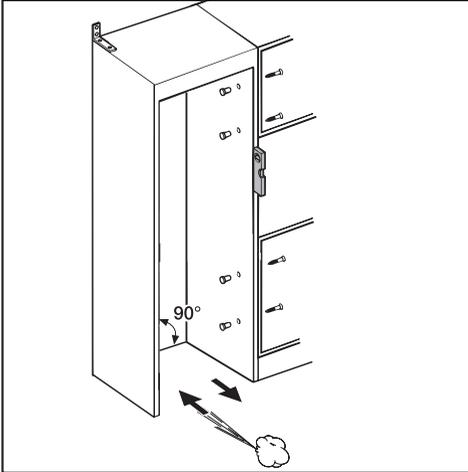
Antes de instalar el aparato, la unidad de empotramiento deberá alinearse con detenimiento usando un nivel de burbuja. Las esquinas de la unidad deberán formar ángulos rectos, de lo contrario la puerta del mueble no se alineará correctamente con las cuatro esquinas del aparato.
