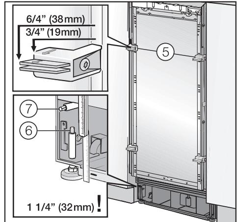
Los elementos auxiliares para la instalación ⑤ se han diseñado para el siguiente grosor total de puertas personalizadas:
